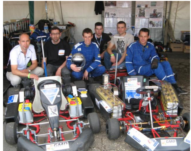
Fig 5 : Karts électriques 2 moteurs 28 kW nominal 48V au plomb à gauche et LiFeYPO4 à droite 96V. Challenge National Vierzon e-Kart 2011.
